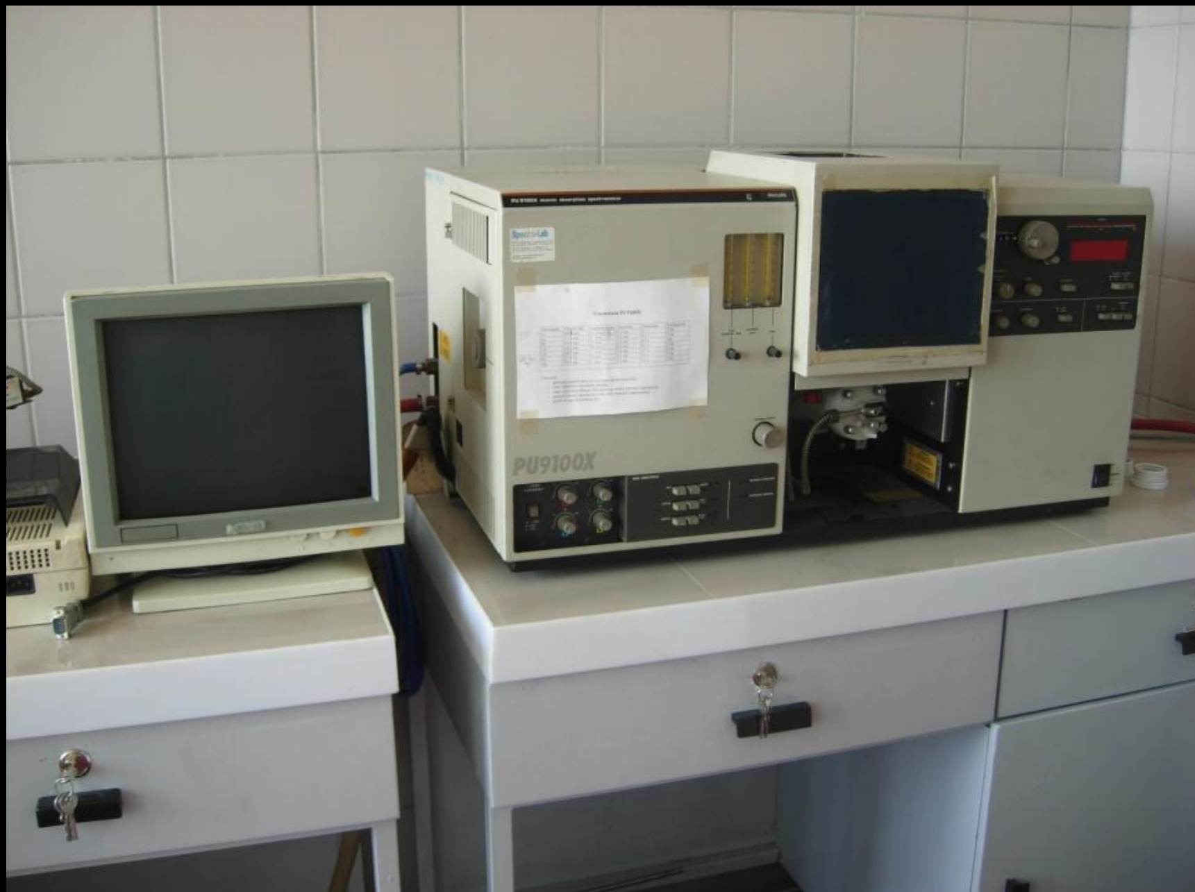
Spektrometr absorpcji atomowej PU 9100 X UNICAM
