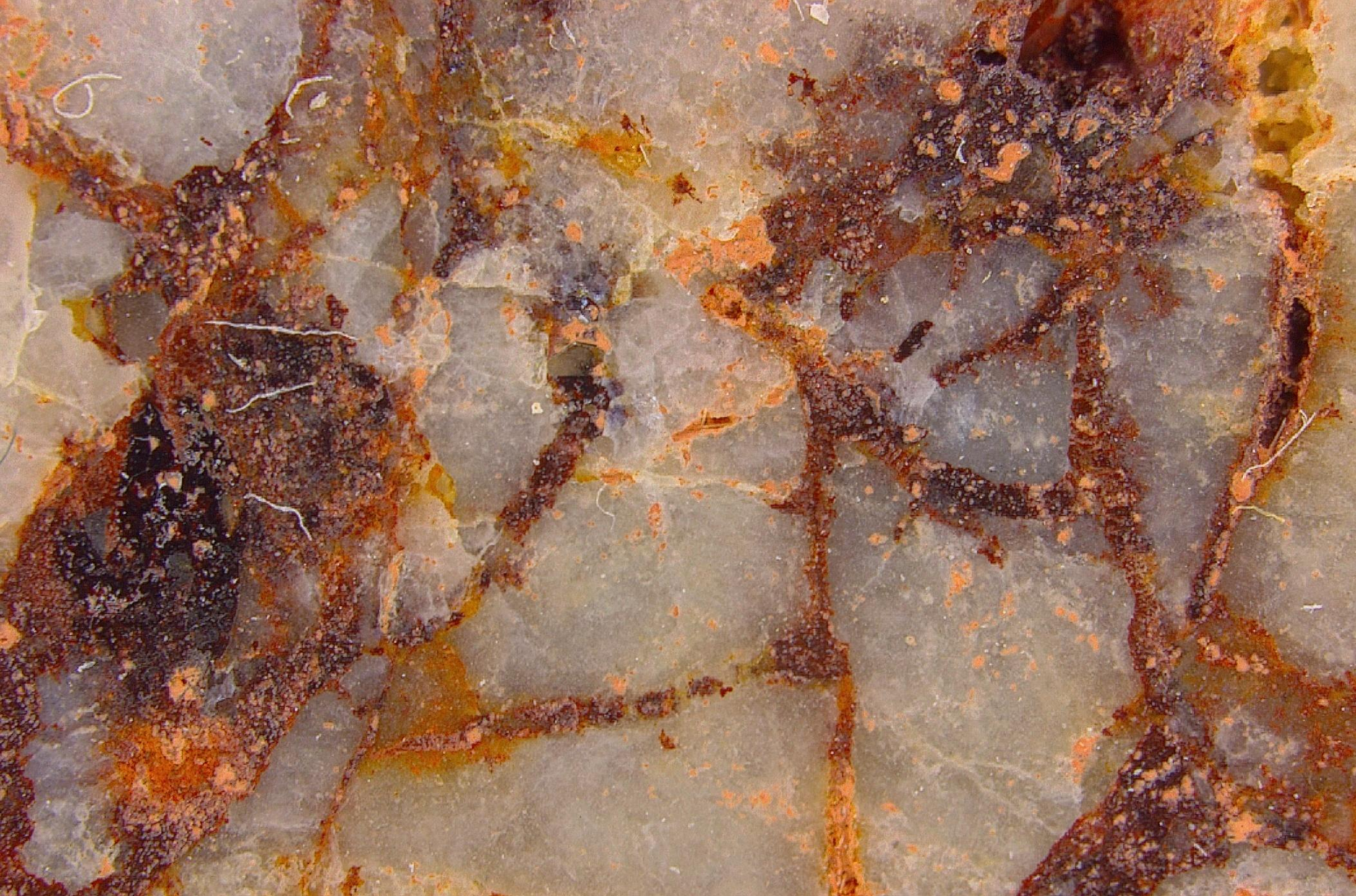
Brekcja kwarcowa scementowana goethytem i hematytem (Podwiśniówka k. Kielc)
